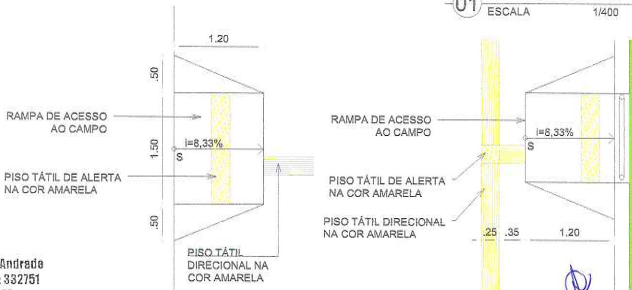
02 DET. RAMPA CALÇADA ESCALA 1/50
