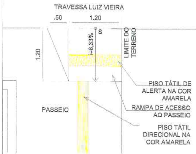
02 DET. RAMPA CALÇADA ESCALA 1/50
